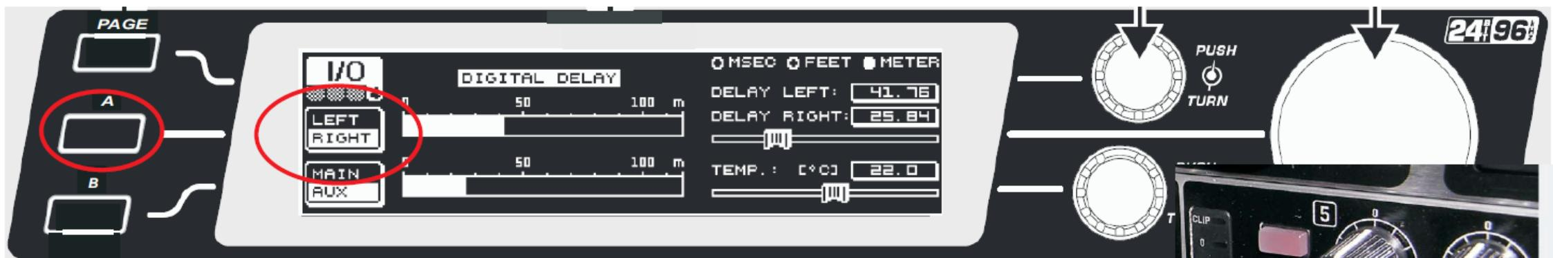
Ako u obje slušalice (na oba uha) želimo dobiti jednaki (MONO) efekt dvostrukog delay-a, na pojačalu za slušalice (na onom kanalu gdje su slušalice uključene) treba pritisnuti oba crvena dugmeta tako da dugme svijetli. Ako se ~~oba~~ dugmata isključe, dobit će se stereo efekt s dva različita zvuka u svakom uhu. Ako se pritisne samo jedno dugme, dobit će se isti zvuk iz jednog kanala u oba uha, a ako se pritisne samo drugo dugme, dobit će se isti zvuk iz drugog kanala u oba uha.
